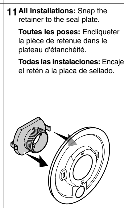
11 All Installations: Snap the retainer to the seal plate. Toutes les poses: Encliqueter la pièce de retenue dans le plateau d'étanchéité. Todas las instalaciones: Encaje el retén a la placa de sellado.
